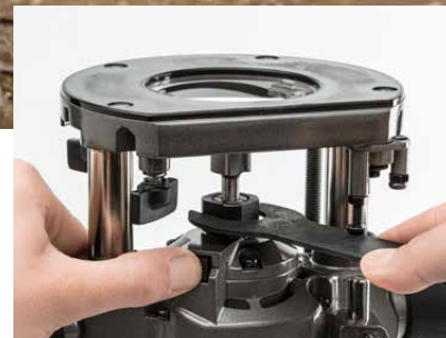
Spindle Lock voor het eenvoudig wisselen van bits.
